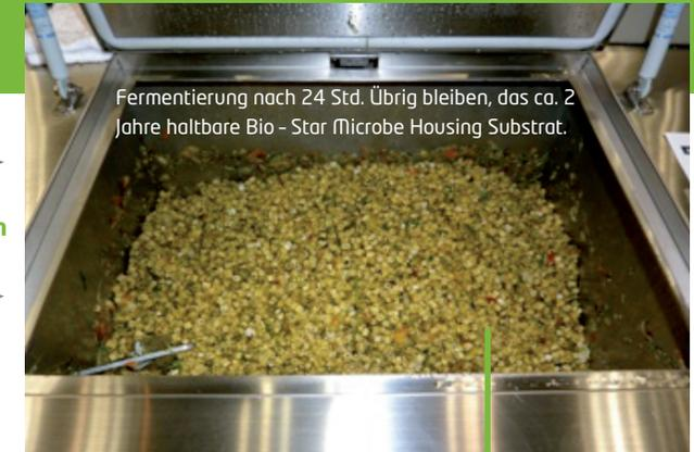
Die Aufbereitungsmethode ist gegensätzlich zur klassischen „Kompostierung“. Die zu entsorgenden Speisereste werden mit Hilfe von Mikroorganismen in Wasser und Kohlendioxid aufgespalten. Es entstehen keine Reste welche nach der Aufbereitung wieder entnommen werden müssen. Wasser und CO<sub>2</sub> werden dem normalen Abwasser oder Klärungsprozess zugeführt.
