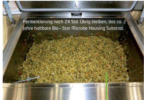
Die Aufbereitungsmethode ist gegensätzlich zur klassischen „Kompostierung“. Die zu entsorgenden Speisereste werden mit Hilfe von Mikroorganismen in Wasser und Kohlendioxid aufgespalten. Es entstehen keine Reste welche nach der Aufbereitung wieder entnommen werden müssen. Das Wasser wird dem normalen Abwasser oder Klärungsprozess zugeführt.
